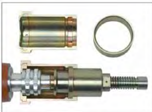
用于拆卸接触环的组件
